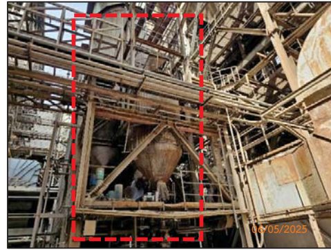
รูปที่ 2-7 โซโลเก็บผงหินปูนแบบปิด
