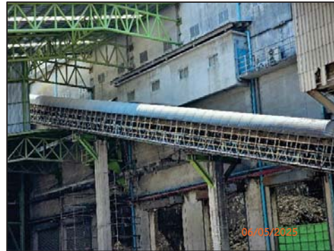
รูปที่ 2-8 สายพานลำเลียงแบบระบบปิด
